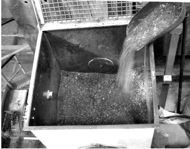
Life LAW – Unità di Carmagnola – Granuli nella tramoggia di immissione in forno
